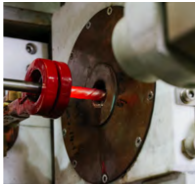
チタン棒材の性質を RMACREO で改良する。世界初の機械を使用しており、自動車メーカーなどの設計者や大学研究者が実験、試作に訪れている。
