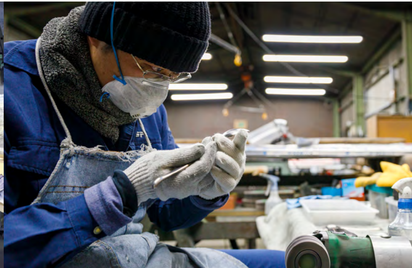
研磨の仕上がりを指先の感覚で確かめる。わずかな凹凸すらも逃すまいと表情は真剣。素手で触れるよりも軍手をつけている方が、滑り具合で表面の滑らかさを確かめやすい。
