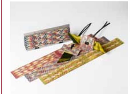
住宅や工場、果樹園など多くの場所で、カラスや鳩などによって発生している鳥害を対策する商品。3Dレンズパネルを用いたデザインとすることで、目の焦点が合わないようになり、「見たくない」と認識させることで、鳥を撃退する大変ユニークな機能を実現している。色や柄、大きさ、厚さ、取り付け方法など、多くの種類をシリーズ化しており、今後の市場拡大が期待できる。
