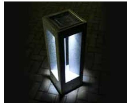
夜間や停電時にソフトな光で足元を照らし、昼間は車道と歩道の境界となるポラードも兼ねるLEDフットライト。配光効率を高めるため、複数のLEDとステンレス板の配置や景観にマッチするように、ポラード表面を御影石調に研磨するなどの工夫が優れている。LEDの色調やポラードの大きさをシリーズ化し、太陽光発電と合せて、メンテナンスフリーを実現した商品となっている。
